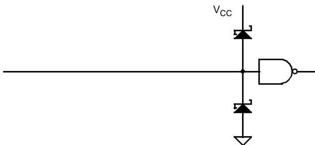
**Figure 19. Schottky Diode Termination**
